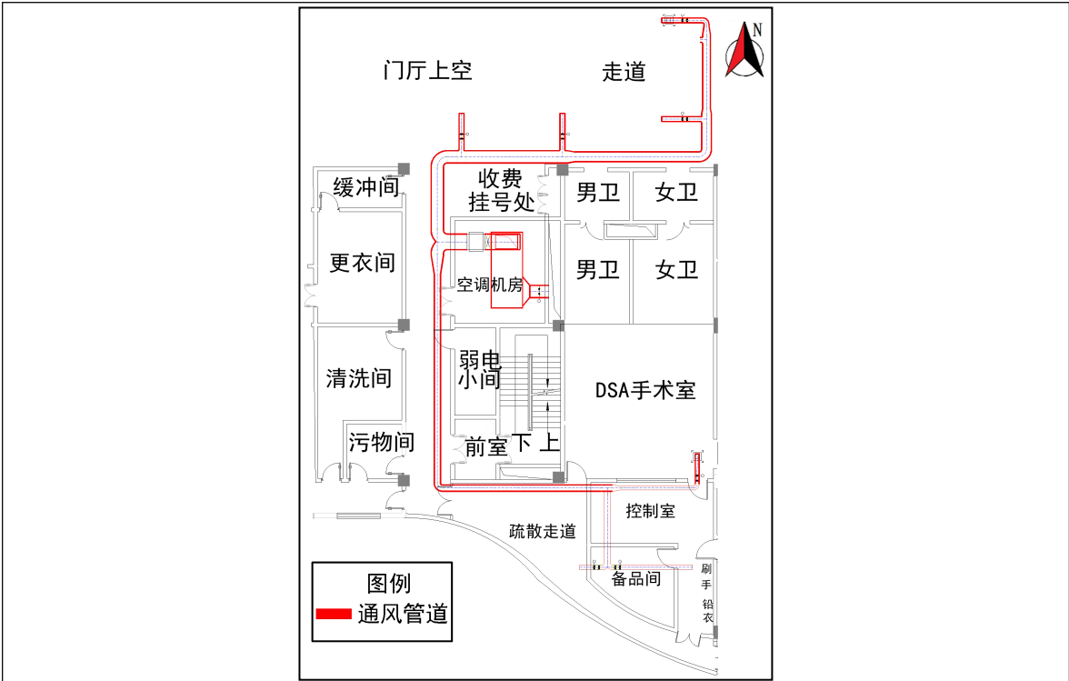
图 10-6 DSA 手术室通风管道路径示意图
